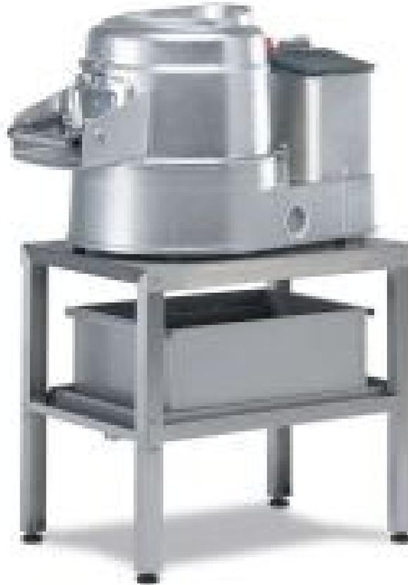
**Peladora de patatas industrial monofásica** de aluminio altamente resistente con una producción de 6 kg. en cada ciclo
