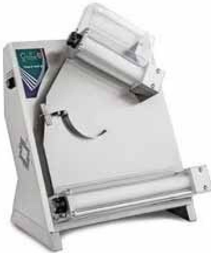
Laminadora **Adler DUALE 310 D30 T.GO** un modelo eficiente para extender la masa de pizza, pan, tortitas, etc. se trata de una laminadora para la producción de masas circulares que nos ahorrará una gran cantidad de tiempo. Cuenta con el sistema patentado Touch and go, mediante un sensor detecta la masa al acercarla a la boca de entrada y enciende los rodillos.
