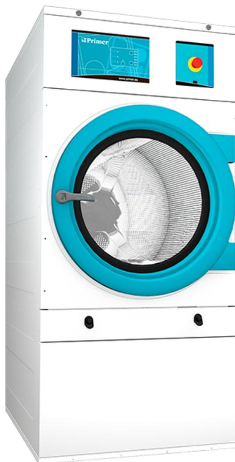
**Secadora industrial línea Básic Primer DL-11P GAS.** Control analógico de tiempo y temperatura de secado. Inversión de giro de serie, para evitar posibles enrollamientos en la ropa y así reducir el tiempo de secado (Spin Stop). Modelos 11/17/23: la transmisión va directamente al eje mediante motor reductor.
