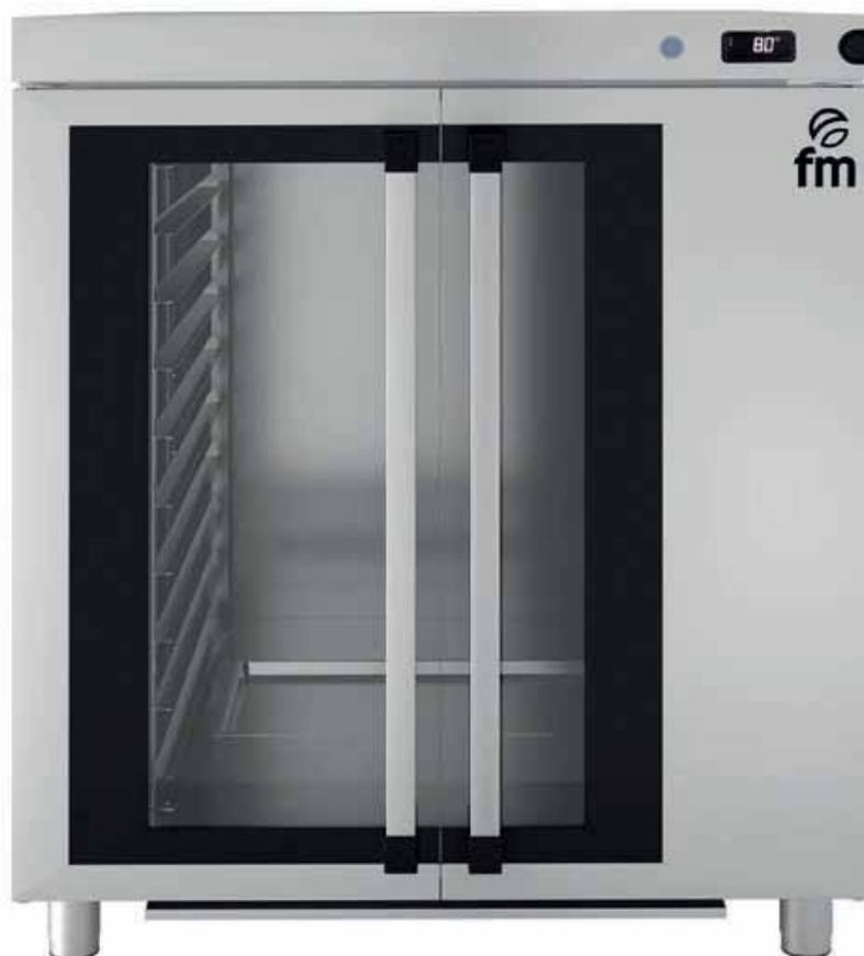
Fermentadora digital **FM STF 620** de 20 bandejas 600x400 / 10 bandejas 600x 800mm perfecta para panaderías y pastelerías con un volumen de trabajo importante que requieran acortar los tiempos de producción. Con control de calor húmedo y seco, la distancia entre bandejas es de 8 cm y alcanza una temperatura máxima de 85°C.
