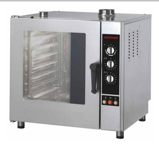
Horno mixto analógico eléctrico **Inoxtrend CDA-107E**, con capacidad para 7 bandejas GN 1/1, para todo tipo de cocinas incluidas las más pequeñas que puede trabajar con cocción a vapor y convección (Vapor directo / Convección /Convección-vapor). Presenta una puerta de doble cristal con cámara y mandos analógicos que nos permiten seleccionar el ciclo deseado, cantidad de vapor y tiempo de cocción
