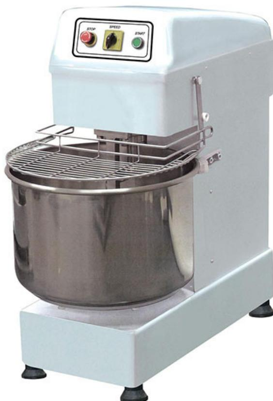
Amasadora profesional **Romagsa** SP 30 H, una amasadora de gancho espiral, con dos velocidades, parrilla protectora de seguridad, botón paro de emergencia, motor con microinterruptor de seguridad, transmisión por cadena, caldero fijo en acero inox y especialmente ideada para elaborar masas duras (pan, pizza, etc) y para una producción grande (unos 20 panes de kg).
