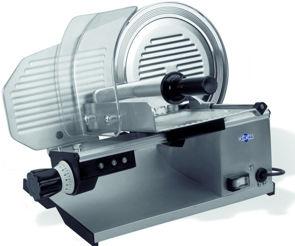
Cortadora de fiambres **Irimar** TOP-220 una máquina para negocios de hostelería construida en aluminio anodizado con transmisión de engranaje plástico eliminando el trabajo de tensar la correa. Presenta un diámetro de cuchilla de 220mm que será perfecto para un corte pequeño y el carro se desplaza sobre cojinetes de acero inoxidable eliminando la necesidad de lubricar las partes deslizables.
