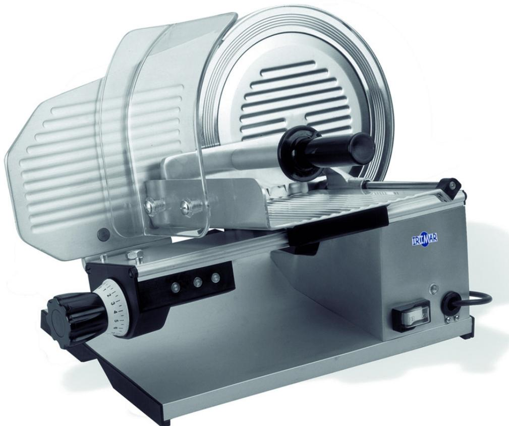
Cortadora de fiambres **Irimar** TOP-250 una máquina para negocios de hostelería construida en aluminio anodizado con transmisión de engranaje plástico eliminando el trabajo de tensar la correa. Presenta un diámetro de cuchilla de 250mm que será perfecto para un corte pequeño y el carro se desplaza sobre cojinetes de acero inoxidable eliminando la necesidad de lubricar las partes deslizables.
